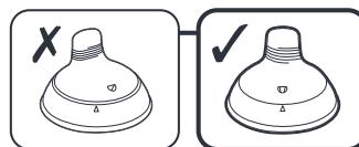
Placez le bec dans l'anneau d'assemblage.
