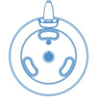
3 Si besoin, ajustez la luminosité en appuyant sur le bouton en dessous jusqu'à ce que la luminosité requise soit atteinte (le **Groegg<sup>2</sup>** possède quatre niveaux d'intensité lumineuse y compris l'extinction complète)
